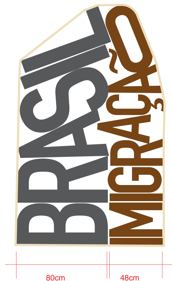
LETRA CAIXA EM CHAPA GALVANIZADA COM PINTURA AUTOMOTIVA. AMARRAÇÃO COM CORDA DE SISAL.
