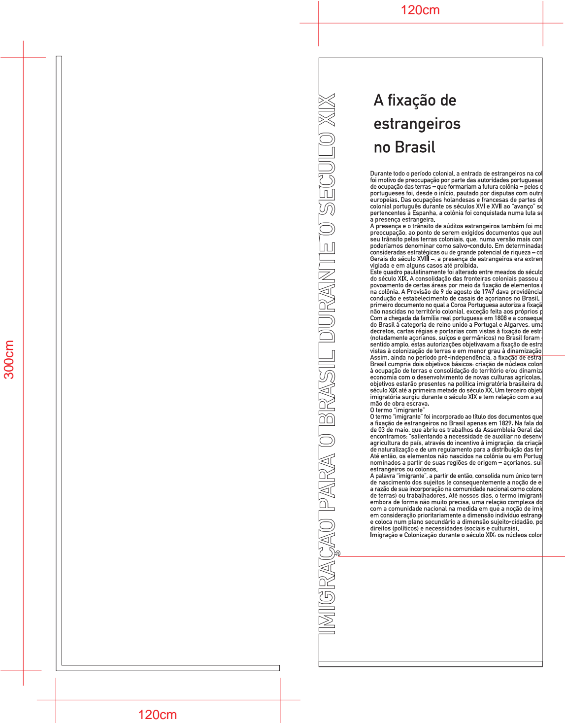
CHAPA DE FERRO DOBRADA COM PINTURA AUTOMOTIVA NA COR PRETA BITOLA 12
